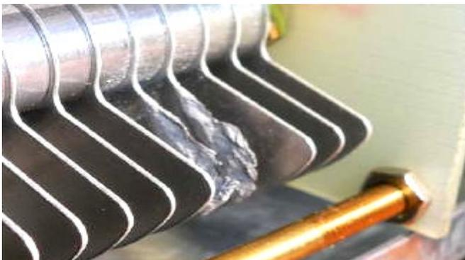
Der Blindwiderstand ist bei der Frequenz  $f = 3.6$  MHz,  $X_c = 884 \Omega$ . Bei einer Leistung von  $P = 1000$  W fließt ein HF-Strom von  $I = 4.45$  A und daraus die Spannung an der Kapazität  $U = 4.45$  A \*  $884 \Omega = 3934$  V bzw. die Spitzenspannung wird  $U_{\max} = 5564$  Vs.
