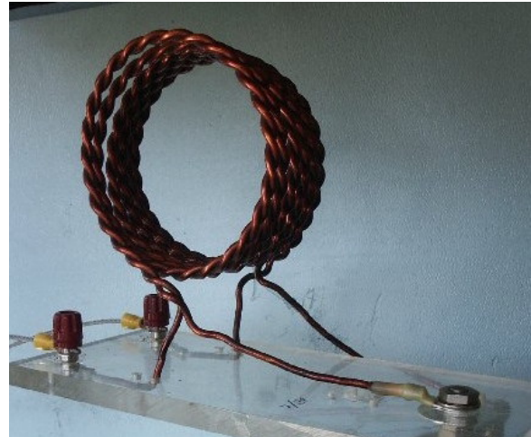
Bild 3: Lufttransformator (Balun) in praktischer Ausführung bei DJ9LI, Rudolf, Bochum
