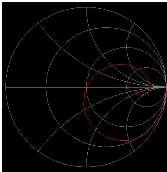
**Bild 3: Verlauf der Eingangsimpedanz einer HP-T-Anpassschaltung im Smith-Diagramm, Referenz ist  $50 \Omega$**
