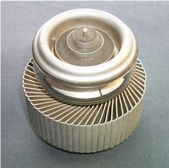
**Bild 1: GU 43 B aus russischer Produktion**
